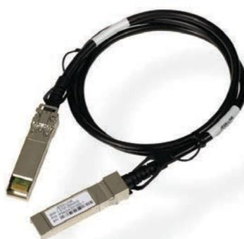
Figure 1 : Câble Direct Attach
