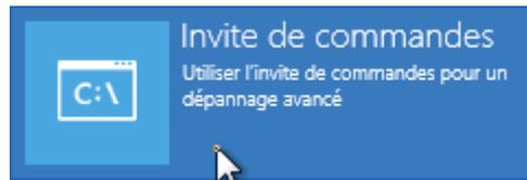
Notamment avec **BootRec.exe** (en invite de commande) suivit des options **/FIXMBR**, **/FIXBOOT** et deux nouvelles **/SCANOS** et **/REBUILDBCD**
